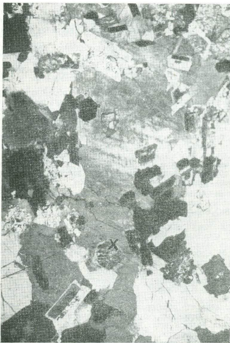
Рис. 11. Крупные зерна калинатрового полевого шпата с включениями по-разному ориентированных реликтовых зерен плагиоклаза, биотита, кордиерита (x) и других минералов.
