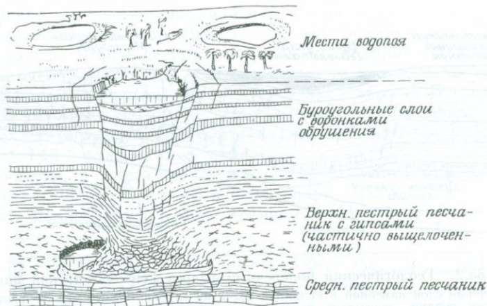
Р и с. 35.3. Поперечный разрез заполненной водой воронки обрушения, возникшей в третичное время в результате выщелачивания гипсов в верхнем пестром песчанике. Многие животные погибли именно в таких воронках, где они пили воду.
