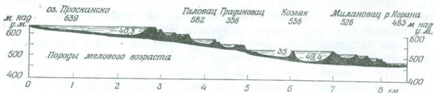
Р и с. 14.2. Продольный разрез Плитвицских озер с плотинами из известкового туфа (черные на рисунке). Вертикальный масштаб увеличен в 20 раз.
