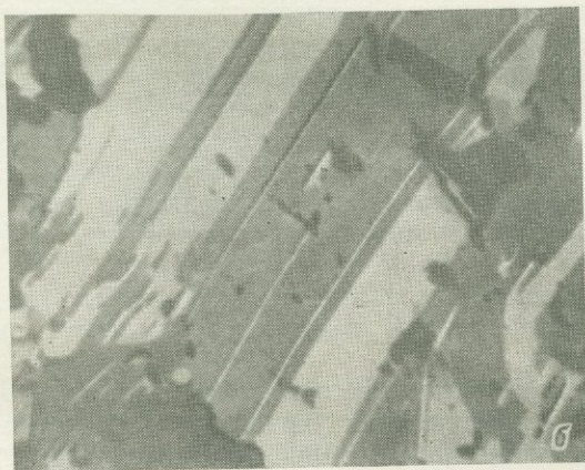
Рис. 124. Механические двойники по одной системе двойникования в антимоните (а, увел. 25) и сульваните (б, увел. 65).
