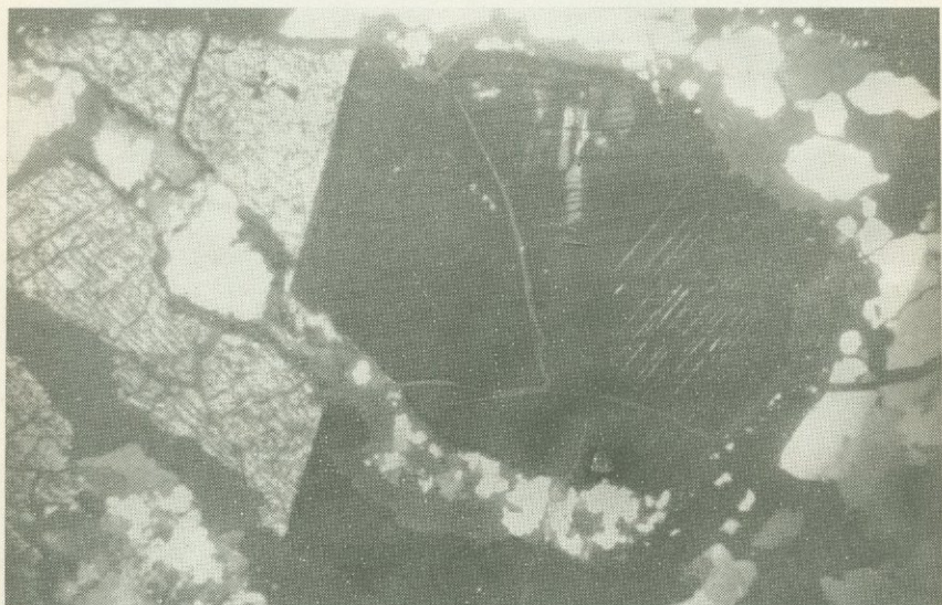
Рис. 126. Двойник роста по e (101) касситерита с вторичными механическими двойниковыми прослойками в поставленном на погасание индивиду. Торговое месторождение, Приполярный Урал. Увел. 120.
