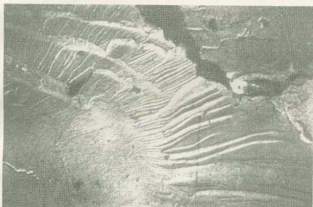
Рис. 42. Раковистый излом урановой смолки. Электронная микрофотография целлюлозно-угольной реплики (по Грицаенко и др., 1961).
