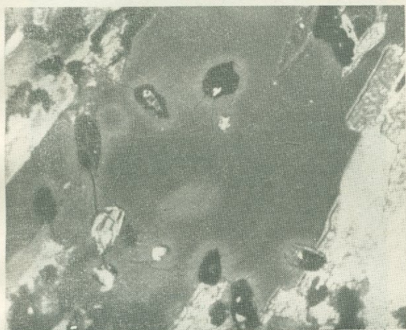
Рис. 153. Радиальные трещины хрупкого разрушения биотита вокруг включений ортита, возникшие в результате метамиктного распада и увеличения объема ортита (биотитовый амфиболит, Приполярный Урал). Увел. 120.
