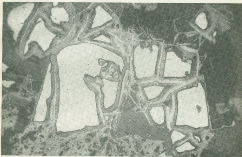
Рис. 160. Окисление пирита по трещинкам с образованием гетита. Приполярный Урал. Увел. 80.
