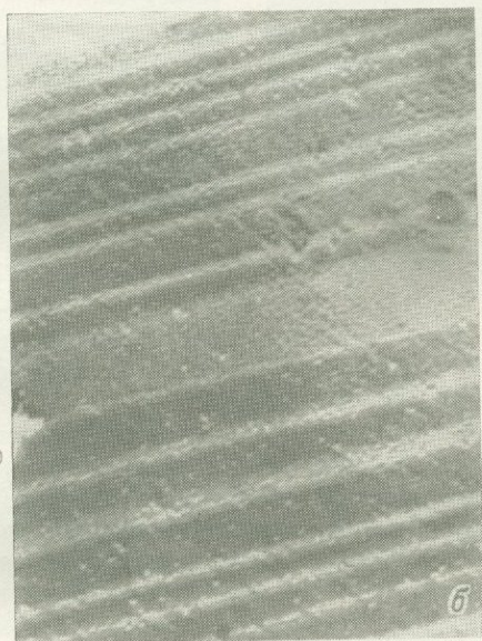
Рис. 46. Волнообразный рельеф на плоскостях спайности кристаллов алмаза (а) и кварца (б), обнаруживающийся с помощью электронного микроскопа.
