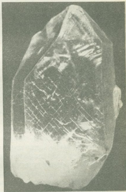
Рис. 156. Растрескивание периферического слоя на грани призмы кристалла кварца вследствие гетерометрии. Приполярный Урал. Увел. 2. Из колл. В. В. Буканова.
