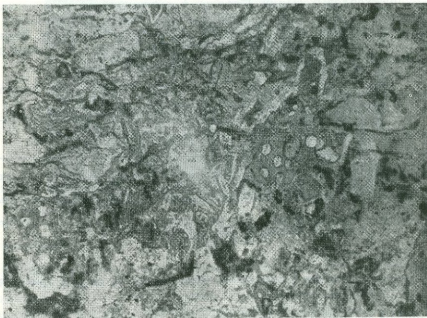
Рис. 7. Липаритовые порфиры жерловой фации. Такситовая структура. \times 8 . Николи+
