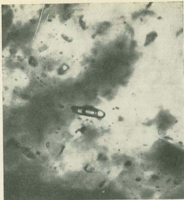
Рис. 3. Многофазовое микровключение с углекислотой в кварце; увел. 90
