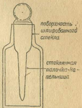
Рис. 16. Пузырек со стеклянной притертой пробкой-капельницей. Величина приблизительно натуральная.
