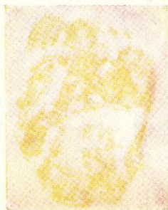
Рис. 28. Прямой отпечаток свинца в галените (желтый). Полированная поверхность минерала травится на шлифе \text{HNO}_3 конц. в течение 60 сек. Остаток кислоты снимается фильтровальной бумагой. Проявитель — \text{KI}
