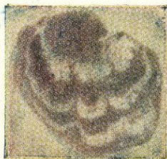
Рис. 29. Прямой отпечаток на \text{Mn}^{4+} в псиломелане (бурый). Растворитель и проявитель — уксуснокислый бензидин, экспозиция 60 сек
