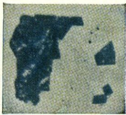
Рис. 23. Отпечаток железа в пирите (синий). Растворитель — \text{HNO}_3 (1:1) с электрическим током, экспозиция 10—30 сек., проявитель — \text{K}_4\text{Fe}(\text{CN})_6 ; растворитель \text{HNO}_3 (1:1), экспозиция 120 сек., проявитель — \text{K}_4\text{Fe}(\text{CN})_6
