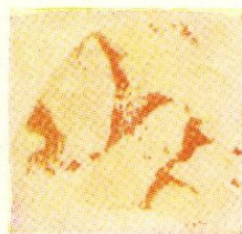
Рис. 22. Отпечаток на селен в клаусталите (оранжево-красный). Растворитель — \text{HCl} (1:1), экспозиция 120 сек; проявитель — тиомочевина
