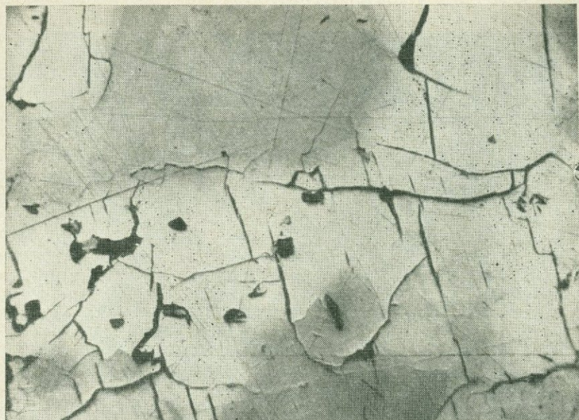
Рис. 13. Халькозин (белое) с трещинками спайности по (001) в борните (серое). Черное — ямки. Месторождение Кафан, Армянская ССР. Полированный шлиф. Ув. 90
