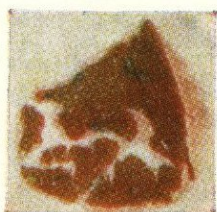
Рис. 19. Отпечаток кобальта в кобальтине (розовато-коричневый). Растворитель — \text{NH}_4\text{OH} с электрическим током, экспозиция 30 сек; проявитель — \alpha -нитрозо- \beta -нафтол
