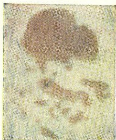
Рис. 27. Отпечаток цинка в сфалерите (светло-фиолетовый). Растворитель — \text{HNO}_3 конц. + \text{Cu}(\text{NO}_3)_2 ; экспозиция 180—300 сек. Предварительно полированная поверхность минерала травится в парах царской водки до потускнения. Проявитель — \text{HgCl}_2 + \text{KCNS}
