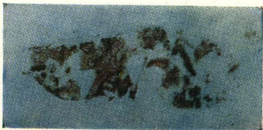
Рис. 25. Отпечаток молибдена в повеллите (коричневый). Растворитель — \text{HNO}_3 (1:1), экспозиция 30 сек.; проявитель — \text{K}_4\text{Fe}(\text{CN})_6
