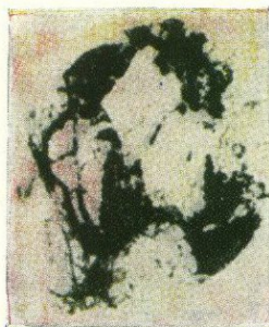
Рис. 20. Отпечаток меди в куприте (темно-зеленый до черного). Растворитель — \text{NH}_4\text{OH} , экспозиция 60 сек; проявитель — рубановая кислота
