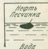
Фиг. 4. Роль поверхностного натяжения в образовании трехфазных эмульсий
