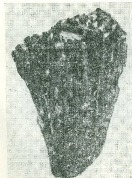
Рис. 11. Параллельно-столбчатые («букетообразные», «кораллообразные») агрегаты пироксенов II (обр. 1793, ум. в 3 раз, м-ние Ингичка).
