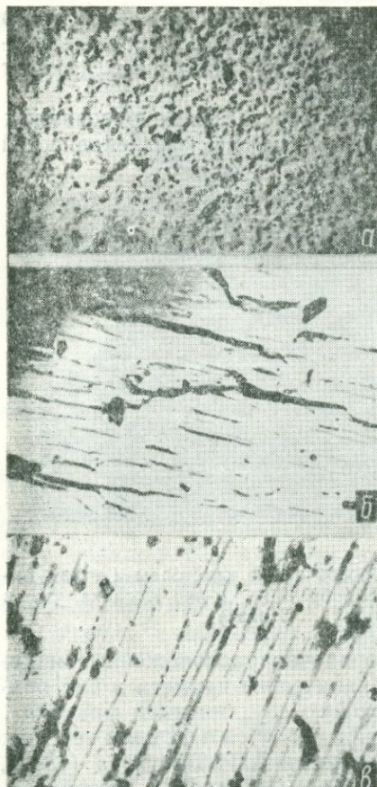
Рис. 15. Реплика со сколов различной степени метаморфизованных пироксеновых II индивидов и агрегатов (электронномикроскопические снимки, ув. 12800).
