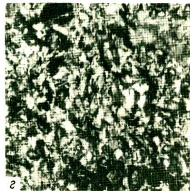
Рис. 8. Пропилитизированные диабазовые порфиры и образующиеся при их лиственитизации метасоматиты, Шульгинское, месторождение, прозр. шлиф, николи скрещены, увел. 52 (см. рис. 7)
