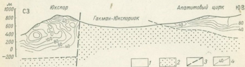
Рис. 8. Продольный разрез через апатитовую залежь на участке Юкспор — Апатитовый Цирк. Пунктиром показано предполагаемое положение линии выклинивания апатитовой залежи. Составили Г. М. Вировлянский и Ю. Н. Благодетелева с использованием материалов СЗГУ
