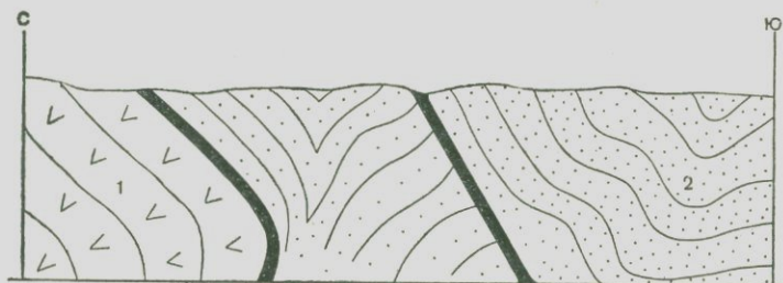
Фиг. 3. Разрез между Акшсаром и Синдирги (длина разреза 200 м). 1—серпентиниты; 2—радиоляриты.
