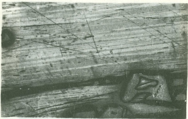
Рис. 18. Полисинтетические двойники в джемсоните. Шлиф полированный, николи неполностью скрещены, увел. 150; темные рельефные зерна - пирит; Центральное (Восточное Забайкалье)
