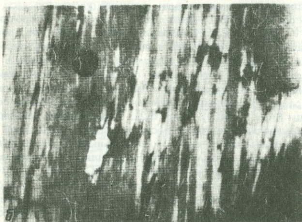
Рис. 19. Полисинтетические двойники в джемсоните. Шлиф прозрачно-полированный, свет инфракрасный, николи скрещены, увел. 40; Тасчан (Китай); снимок сделан на инфракрасную пленку
