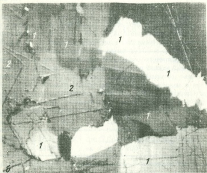
Рис. 5. Менегинит (1) с галенитом (2). Шлиф полированный, увел. 150; Алгачи, Восточное Забайкалье (обр. 136/12, Горный музей) а - без анализатора, б - в скрещенных николях
