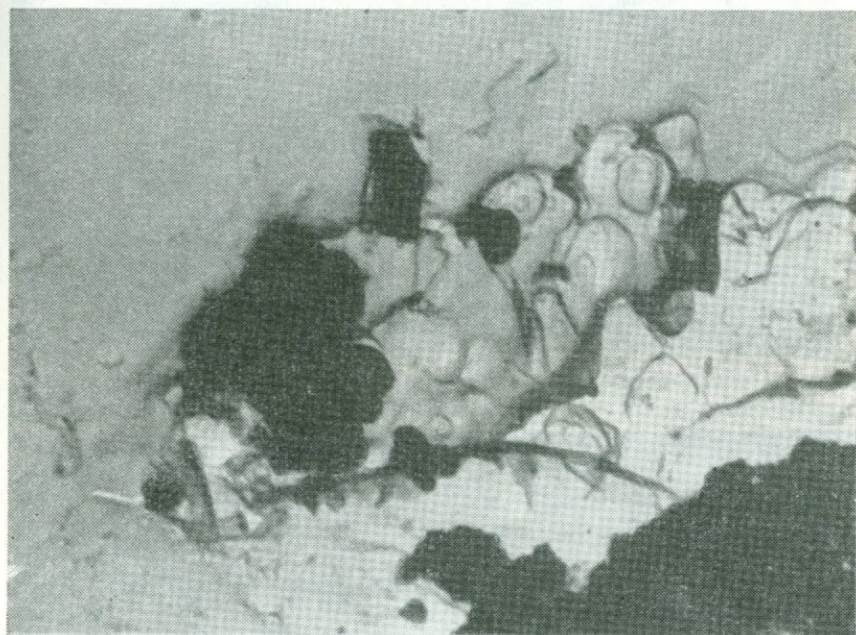
Рис. 62. Глобулярно-почковидное строение метаколлоидного сфалерита из чана. Угольная реплика со скола. Увел. 9000.
