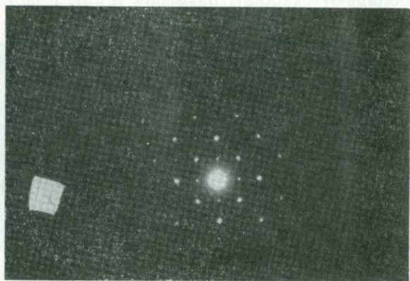
Рис. 40. Картина микродифракции макинавита (недеформированная частица). Снято А. И. Горшковым.
