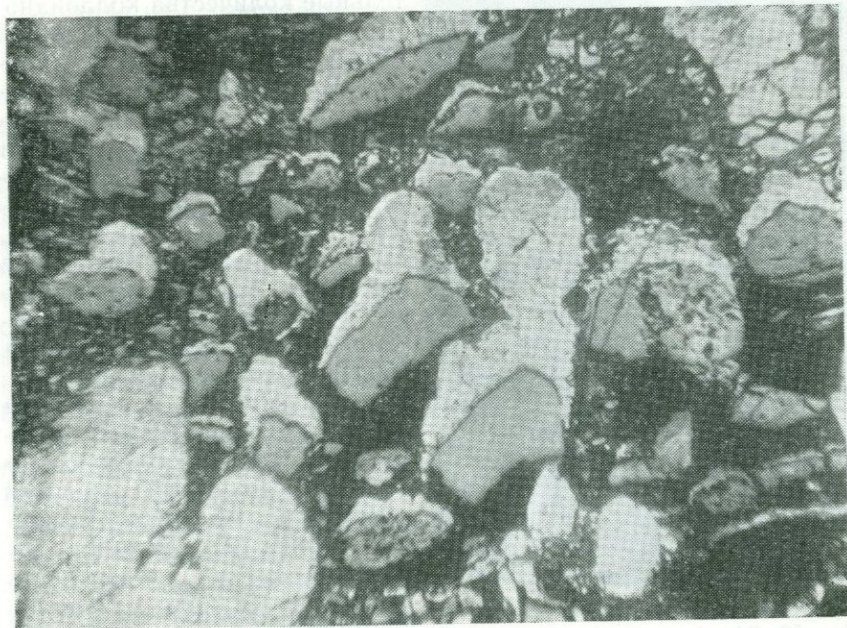
Рис. 71. Ориентированное нарастание сфалерита на песчинки. Отраженный свет. Увел. 90.
