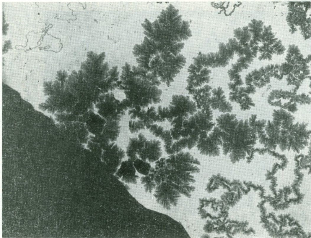
Рис. 45. Дендриты мельниковита на поверхности нитевидных агрегатов глобуль аморфного FeS. Увед. 12 000.
