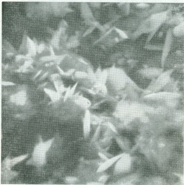
Рис. 42. Пластинчатые кристаллы макинавита на поверхности терригенных частиц. Увел 20 000.
