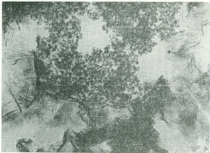
Рис. 36. Изометричные кристаллики канзита (в центре), ассоциирующие с макинавитом (пластинчатые кристаллы по периферии). Возраст четыре месяца. Увел. 20 000.
