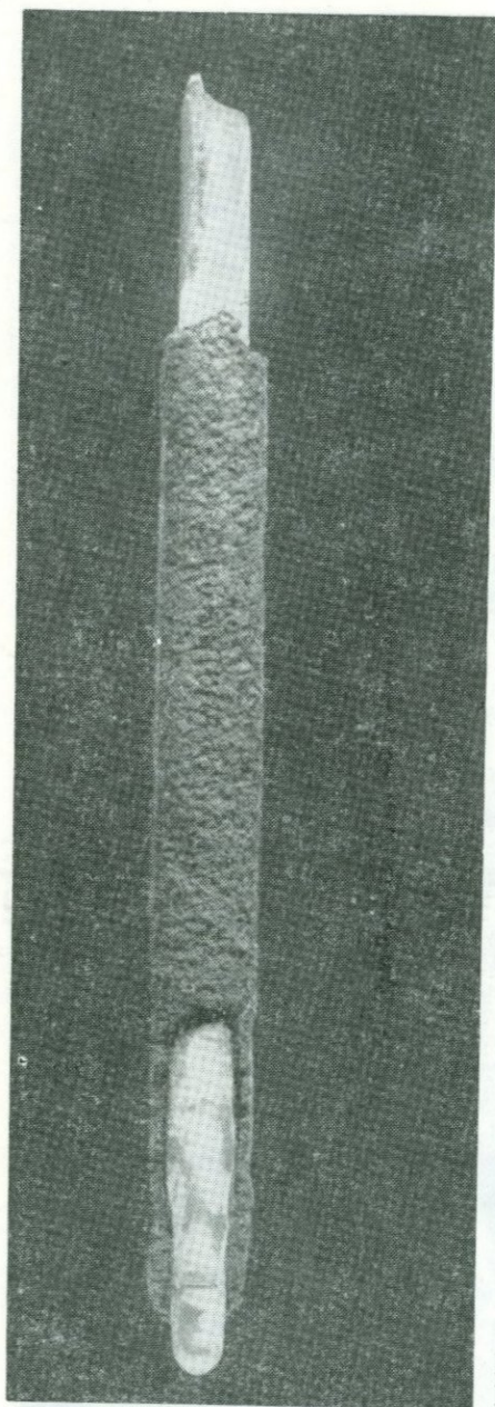
Рис. 72. Сфалерит на обломке термометра. Период образования 2,5 месяца. Natur. вел.
