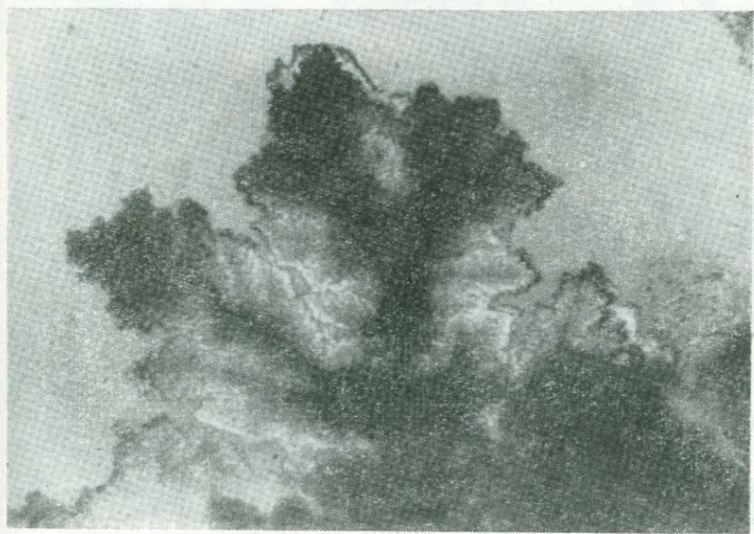
Рис. 27. Дендриты самородной меди, местами перекрывающиеся тонкой корочкой самородного серебра. Отраженный свет. Увел. 165.
