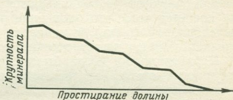
Рис. 6. Кривая гранулометрического распределения тяжелых минералов в россыпи, питающейся из одного рудного тела
