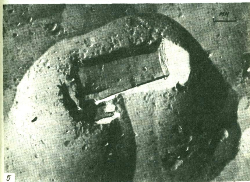
Фиг. 16. Структура темной полосы под электронным микроскопом, образец подвергался гидротермальной обработке при 400^{\circ} и давлении 500 атм, угольная одноступенчатая реплика
