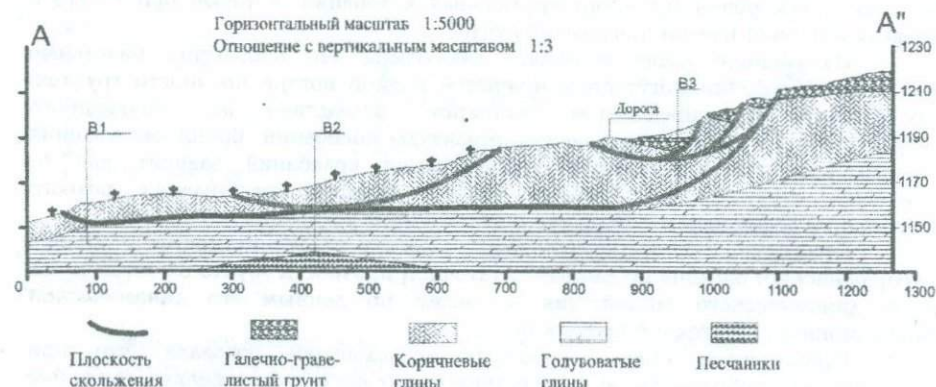
Рис. 3.4.1. Инженерно-геологический разрез Нубарашенского оползневой участка.
