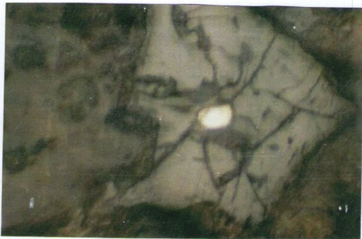
Рис. 3.14. Включение борнита (светлое) в лимоните (серое). Цахкашен. Полированный шлиф Цах-5, ув. х 140. Пл. 3542, к.18.
