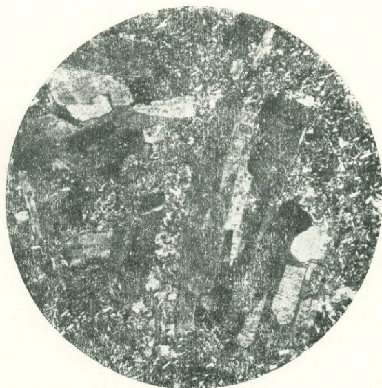
Фиг. 2. Андезит холмов N от г. Одзиконд. Вкрапленники плагиоклаза и основная масса. (Обр. № 156, \times 40 )
