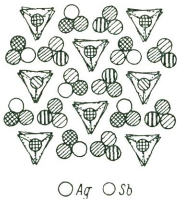
Рис. 4. Структура пираргирита; проекция на базис.
