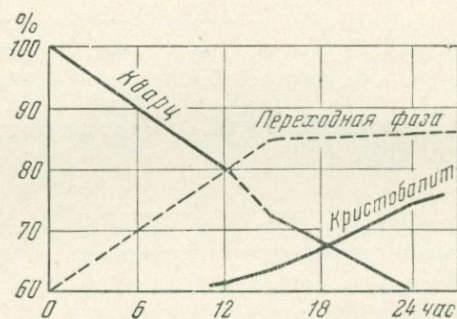
Фиг. 116. Превращение бразильского кварца в кристобалит при 1530°, средний диаметр зерен 0,137 мм (по Чекледеру)
