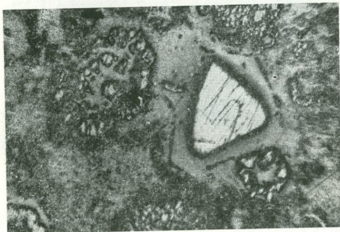
Фиг. 26. Выделение пирита (белое) двух генераций. Борнит (серое) окаймляет кристаллы пирита (треугольник) и развивается внутри сферического тела колломорфного пирита. Дастакерт. Полир. шлиф, \times 400 .
