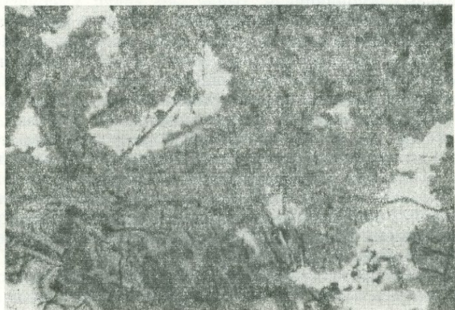
Фиг. 37. Колломорфные выделения лимонита (серое) и малахита (темно-серое) с трещинами усыхания, образованные за счет халькопирита (белое). Каджаран. Полир. шлиф, \times 200 .
