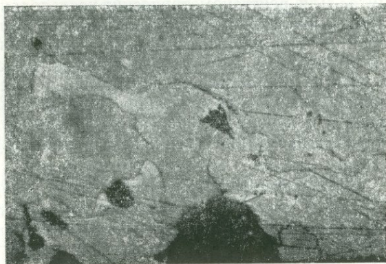
Фиг. 23. Замещение висмутина (белое) виттихенитом (серое) в поле халькопирита (светло-серое). Дастакерт. Полир. шлиф, x115.
