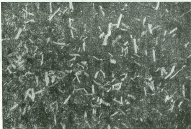
Фиг. 31. Чешуйки молибденита (серовато-белое) в кварце (темно-серое). Агарак. Полир. шлиф, x200.
