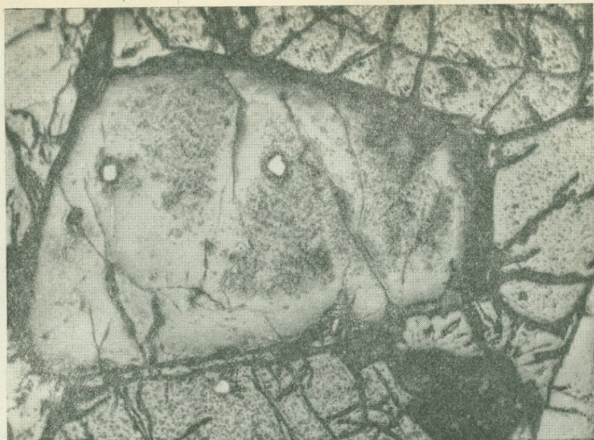
Фиг. 4. Зональное зерно оливина. Хорошо видна кайма вокруг протравившейся центральной части зерна и отдельных его обломков. Отраженный свет, увел. 45. Обр. 112-75. Дунит, Довыренский массив
