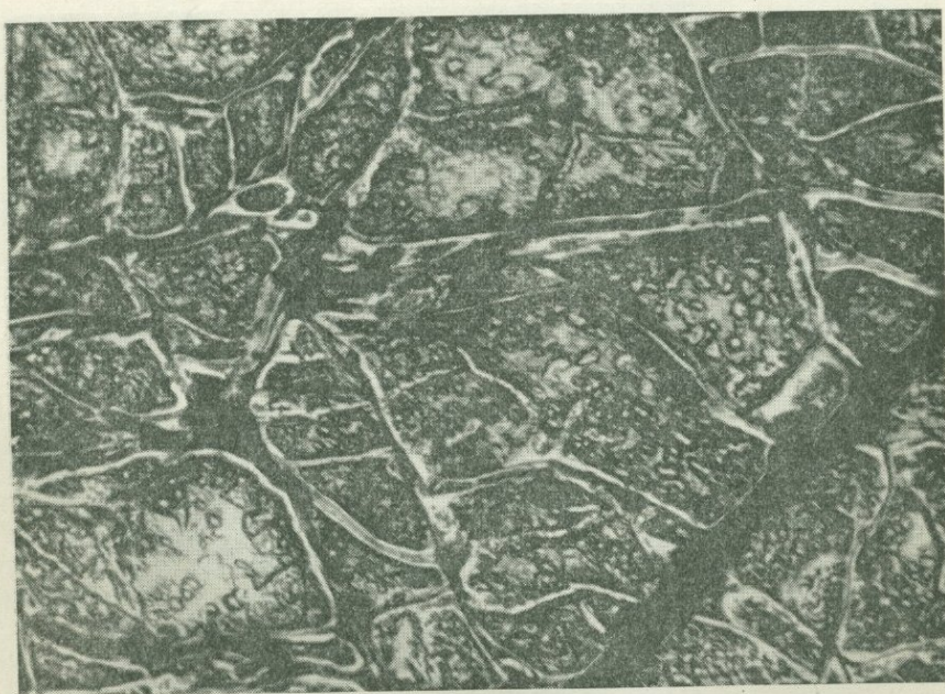
Фиг. 5. Участок мелко раздробленного зерна оливина. Видны светлые однородные каймы вокруг каждого обломка и неоднородное строение центральных частей обломков. Отраженный свет, увел. 100. Обр. 33. Дунит, массив Рай-Из
