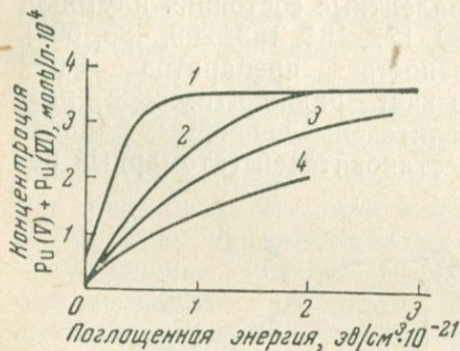
Рис. 21. Окисление плутония под действием рентгеновского излучения в растворах 3 М \text{HNO}_3 и \text{NaNO}_3 1 — без \text{NaNO}_3 ; 2 — 0,35 М \text{NaNO}_3 ; 3 — 0,88 М \text{NaNO}_3 ; 4 — 1,76 М \text{NaNO}_3 . Концентрация \text{Pu(IV)} — 3,4 \cdot 10^{-4} М
