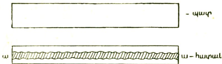
Նկ. 41. Առվի գծագիրը. օգտակար հանածոյի ուղղաձիգ մարմինը մերկաց- ված է փորվածքի կենտրոնում՝ ըստ նրա տարածման ուղղութեան: ա-ա—Օգտակար հանածոյի մարմին:
