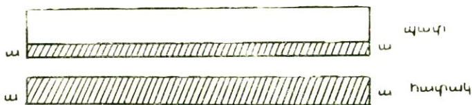
նկ. 36. Առուն մերկացրել է օգտակար հանածոյի հորիզոնական մարմինը: ա-ա—Օգտակար հանածոյի մարմին:
