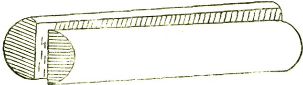
Նկ. 100. Հանուկը երկայնակի առանցքով, բաժանված 2 հավասար մասերի:
