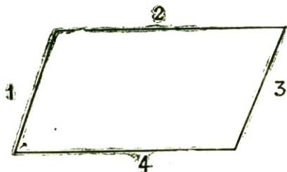
Նկ. 38. Ստորգետնյա հորիզոնական փորվածքի զծագիրը: Օգտակար հանածոյի հորիզոնական մարմինը մերկացված է փորվածքի առաստաղում:
