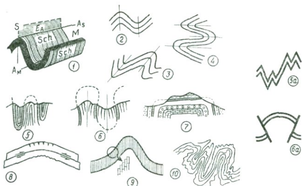
Рис. 22. Схематическое изображение типов складок. 1 — строение складки ( S — антиклиналь, M — синклиналь, Sch — крыло складки, A M — ось синклинали, A S — ось антиклинали, E A — осевая плоскость; 2 — прямая складка; 3 — опрокинутая складка; 4 — лежащая складка; 5 — изоклиальная складка; 5a — остроугольная складка; 6 — веерообразная складка; 6a — грибовидная складка; 7 — сундучная складка; 8 — схема складки изгиба (излома); 9 — схема складки скальвания; 10 — складка течения.
