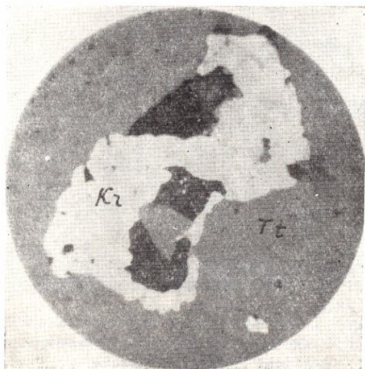
Рис. 25. Выделение креннерита (Kz) в поле тетраэдрита (Td). Каджаранское месторождение. Полир. шлиф. \times 350 . По А. С. Фармазяну.
