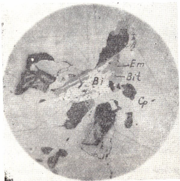
Рис. 23. Выделение висмутила (Bi) в страстании с виттихенитом (Vit) и эмплектитом (Em) в поле халькопирита (Cr). Каджаранское месторождение. Полир. шлиф. (иммерсия). \times 450 . По А. С. Фармазяну.
