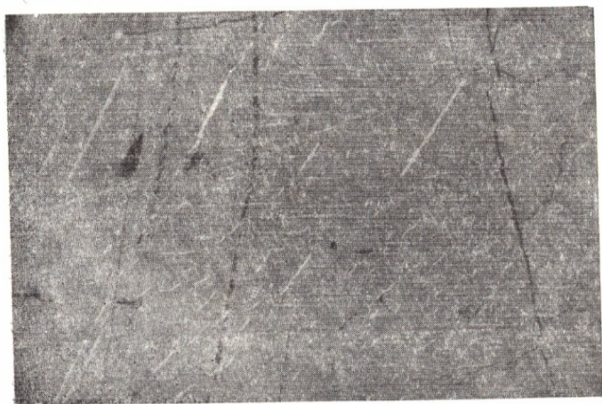
Рис. 33. Развитие виттихенита (белое) по определенным кристаллографическим направлениям борнита (общее поле). Анкаванское месторождение. Полир. шлиф. \times 365 . По А. И. Карапетяну.
