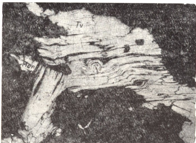
Рис. 8. Пластинчатые выделения теллуrowисмутита (Tv) в кварце. Серое—монтанит (Mon). Зодское месторождение. Полир. шлиф. \times 100 . По Ш. О. Амиряну.
