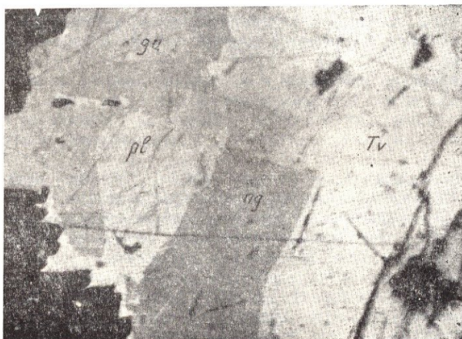
Рис. 12. Сростания теллурического висмутита (Tv), пильзенита (Pl), галенита (ga) и нагиагита (ng). Зодское месторождение. Полир. шлиф. \times 100 . По Ш. О. Амиряну.
