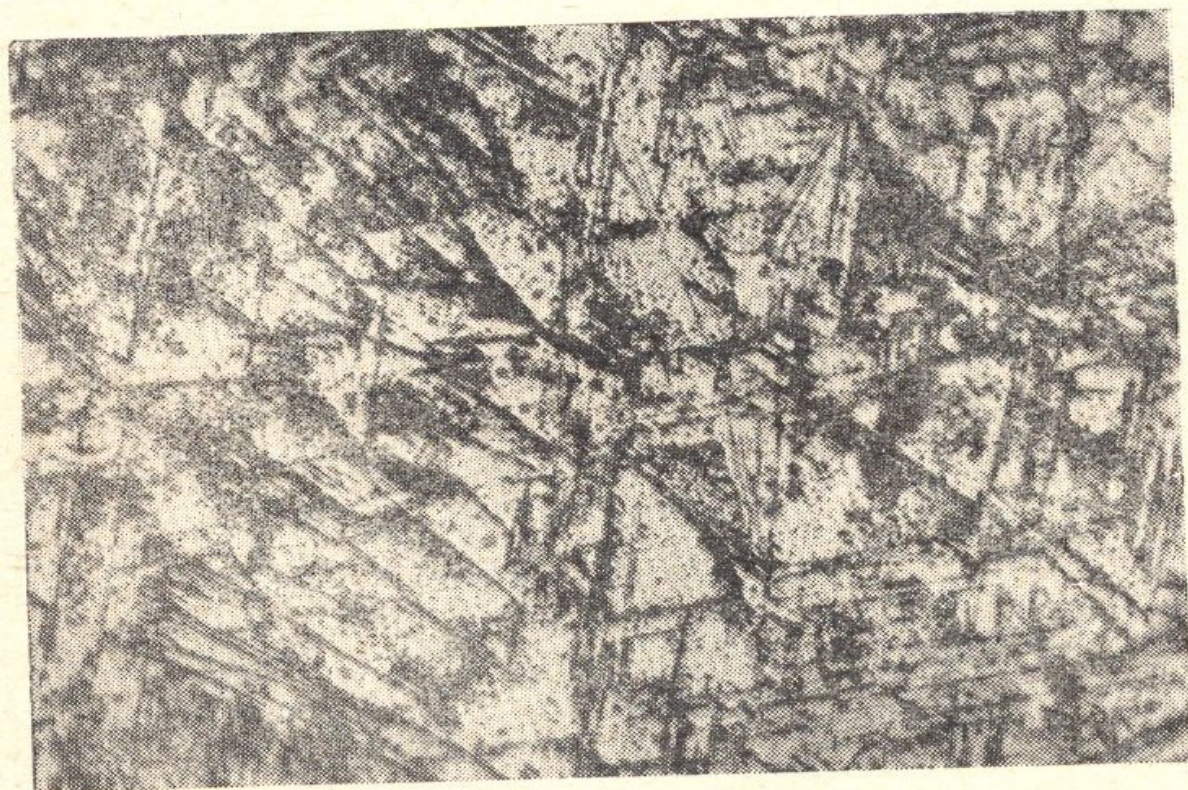
Фиг. 39. Нацело метаморфизованная руда хромита. Месторождение Нижней Дары. Замещение хромитового вещества происходит по трем направлениям, отвечающим спайности. Аншлиф. Увелич. 35. Без анализатора.
