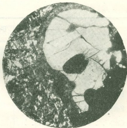
Фиг. 13. Андезитобазальт; по середине оплавленное зерно кварца с оторочкой из авгитовых иголец. (Увел. 60, поляриз. свет).
