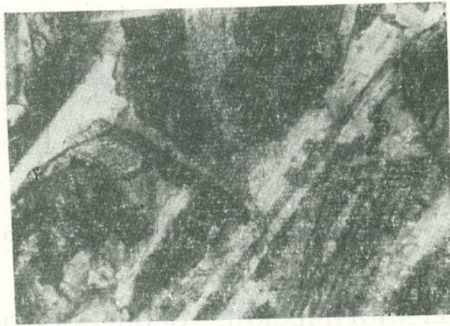
Фиг. 29. Радиально-лучистые трещины в зернах плагиоклаза. Шл. 1077/54, Ахтала. (ув. 120 ник. +).
