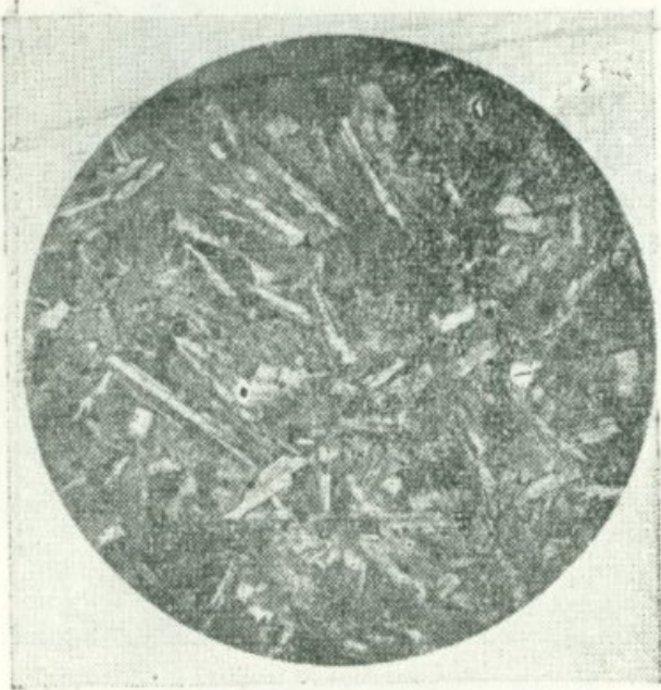
Фиг. 10 1 . Обр. 283/51. d поля зрения 2,3 мм, николи скрещены. Диабаз. Микродиабазовая структура.
