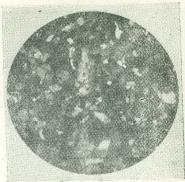
Фиг. 2. Обр. 237/51, d поля зрения 2,3 мм, николи скрещены. Сильно глинистый алевритистый, мелкозернистый песчаник. Алевропсаммитовая структура.
