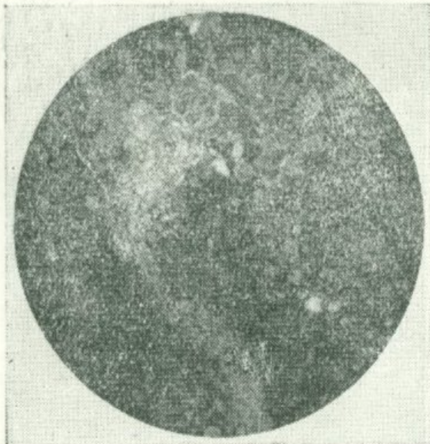
Фиг. 44. Обр. 154/51. d поля зрения 2,3 мм, без анализатора. Мергелевидный известняк. Органиогенно-пелитовая структура.
