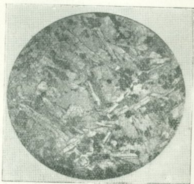
Фиг. 10. Обр. 283/51. d поля зрения 2,3 мм, без анализатора. Диабаз. Микродиабазовая структура.
