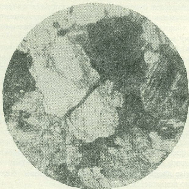
Фиг. 28. Пересечение плагиоклаза микропрожилком сфена поздней генерации в гибридных диоритах Кохбского массива, Увелич. 55. Николи +.
