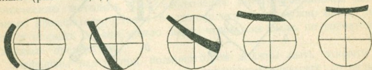
Рис. 527. Схема движения в поле зрения ветви гиперболы интерференционной фигуры двусосного кристалла, при вращении столика микроскопа.
