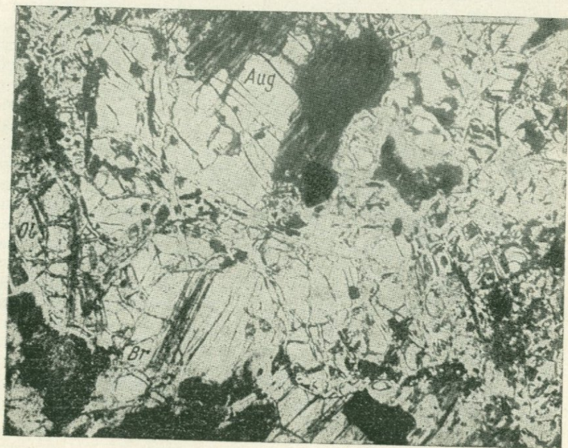
Рис. 31. Лерцолит левобережья р. Катэн. Видны реликты оливина в бронзите и замещение последнего с краев авгитом. Авгит и титаномагнетит замещаются роговой обманкой. Ув. 72, с анализатором
