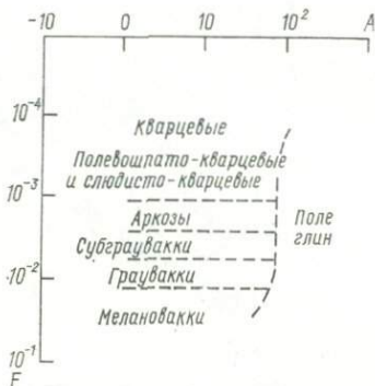
Рис. 26. Диаграмма F — A для определения минерального вида песчаников [26].
