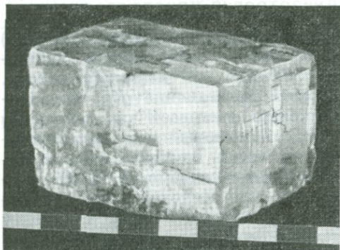
Фиг. 2-80. Спайность по ромбоэдру в кальците. Черные и белые участки шкалы равны 1 см.
