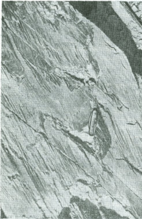
Фиг. 3-10. Кливаж сланцеватости (круто падающий), ориентированный под углом к слоистости (полого падающей) в аргиллите.
