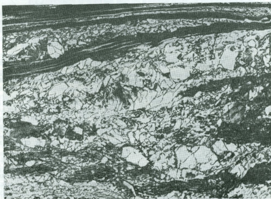
Фиг. 3-7. Катакластическая структура в перемятых гнейсах; диаметр самых крупных обломков равен примерно 0,3 мм.
