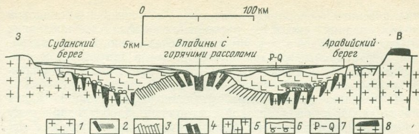
Рис. 67. Схематический профиль через Красное море между 19° и 24° в. д. По Эль Тайебу (1979 г.), Кохрану (1981 г.) и Иззельдину (1982 г.). Структуры фундамента не в масштабе. По И. Тиссу и др. (1983 г.)
