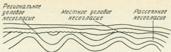
Рис. 28. Переход региональных угловых несогласий в местные и местных угловых несогласий в рассеянное несогласие. По В. Е. Хаину (1973 г.)
