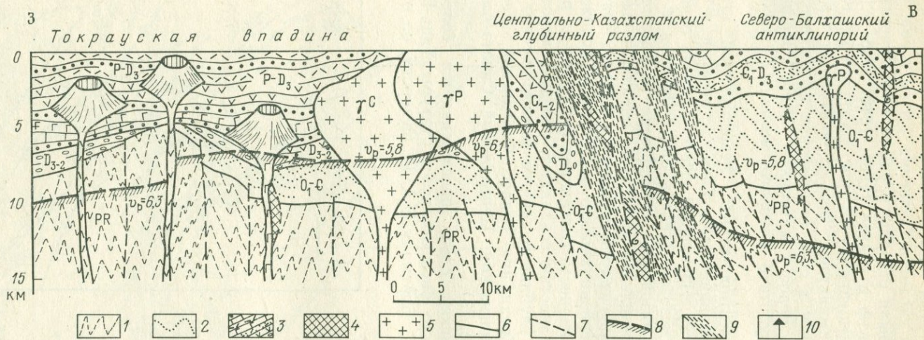
Рис. 73. Разрез через Центрально-Казахстанский глубинный разлом. По А. Е. Михайлову (1977 г.)
