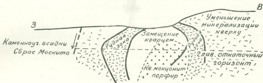
Рис. 43. Идеализированный разрез минерализованной трубы. Молибденовое м-ние Клаймакс. По Д. Вандервильту.
