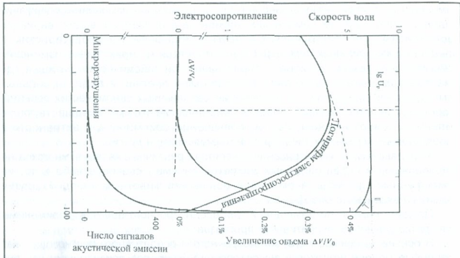
Рис. 2.3 (1) Изменения физических свойств гранита под действием сжимающего напряжения. Испытания проводились на граните Уэстерли при давлении обжима порядка нескольких килобар. По оси абсцисс – доля (в процентах) от напряжения при разрушении. (Символы || и \perp обозначают соответственно компоненты скорости волны, параллельную и перпендикулярную оси сжимающего напряжения.) (Brace, 1968; Scholz, 1968).
