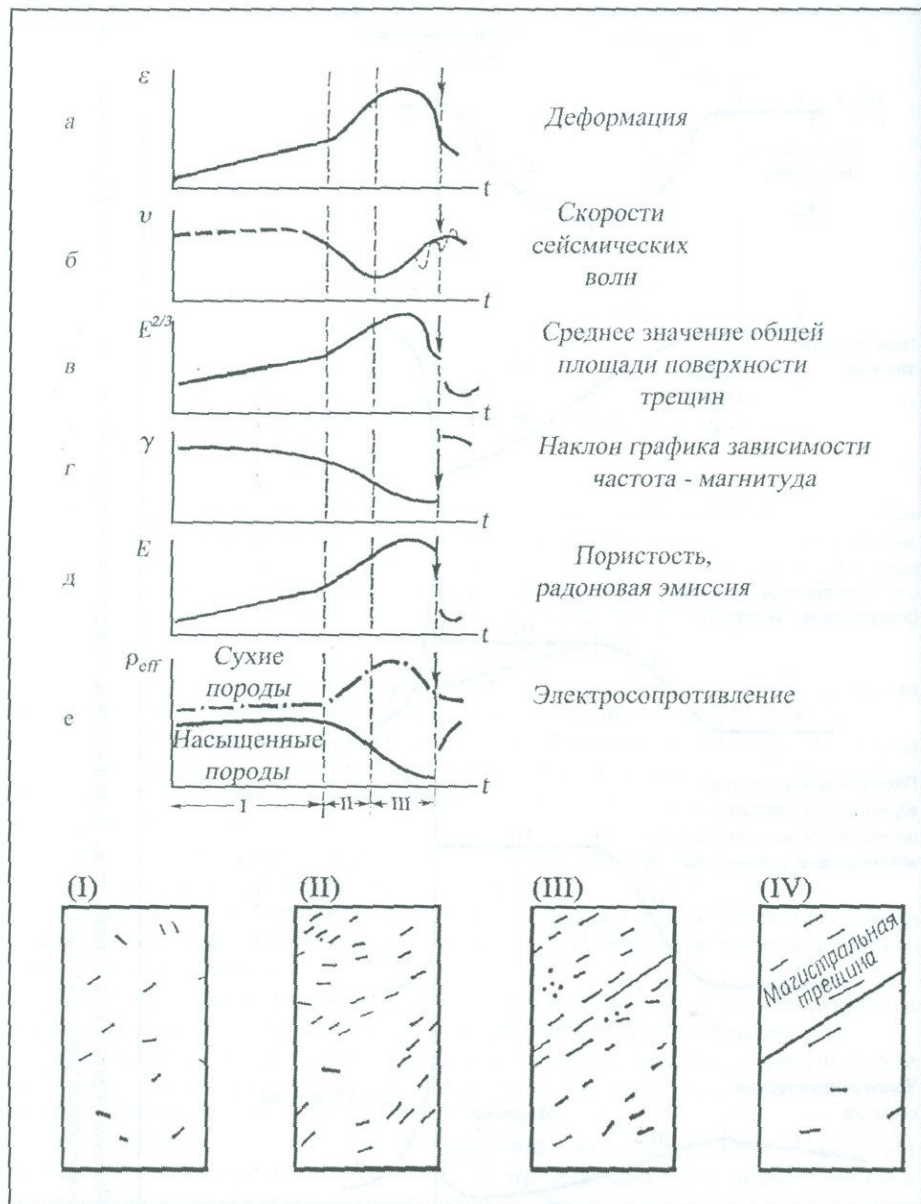
Рис. 2.3(3) Изменения физических параметров в ИФЗ-модели. Развитие разрушения в четырех основных стадиях сейсмического цикла показано в нижней части рисунка. (Mjачкин et al, 1975)
