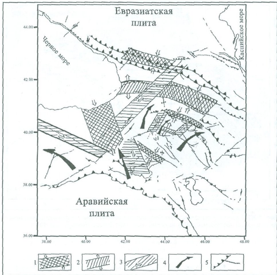
Рис. 1.5(28) Зоны напряжений типа сжатие (1), растяжение (2), сдвиг (3) на Кавказе и Армянском нагорье, полученные по данным спутниковой геодезии (GPS-наблюдения), с направлением движения активных блоков (4) и позицией образованных надвигов (5) (по С.Ю. Баласаняну).
