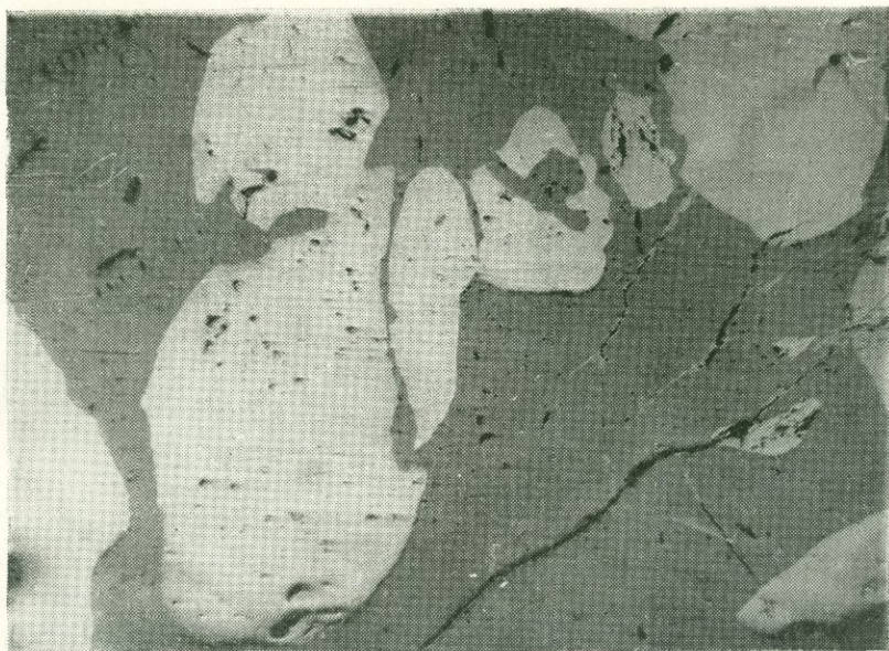
Рис. 49. Срастание борнита (темно-серое) с халькопиритом (белое). Борнит выделяется в промежутках между зерен халькопирита, образуя жилкообразные выделения, шл. 110, х 40. М-ние Дастакерт.
