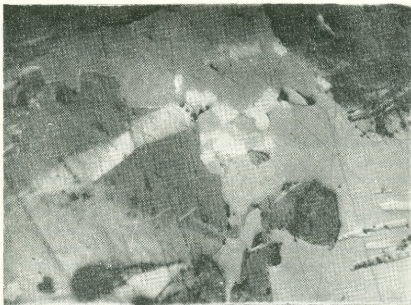
Рис. 72. Скопления пластинок молибденита (темно-серое разных оттенков) и мелких зерен висмутина? (белое) среди халькопирита (светло-серый), шл. 107, х 165. М-ние Дастакерт.
