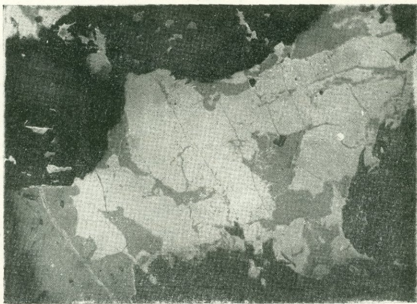
Рис. 51. Срастание борнита (серое) с халькозином (белое) с признаками замещения, шл. 105, х 165. М-ние Дастакерт.
