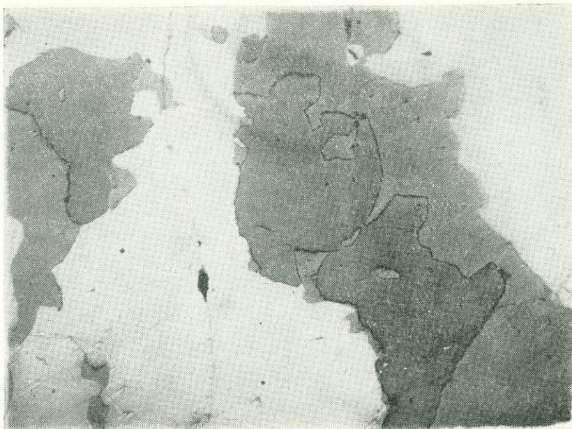
Рис. 60. Выделения сфалерита (темное) среди борнита (серое). Белое— халькопирит, шл. 115, х 40. М-ние Дастакерт.
