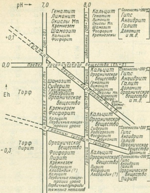
18.3. Конечные ассоциации в химических осадках и характерные для них условия среды в зависимости от Eh и pH.
