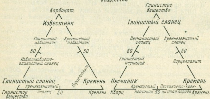
18.1. Четыре грани главного классификационного тетраэдра осадочных пород (тетраэдр показан в центре) [Krumbein W. C., Sloss L. L., 1955 г.]
