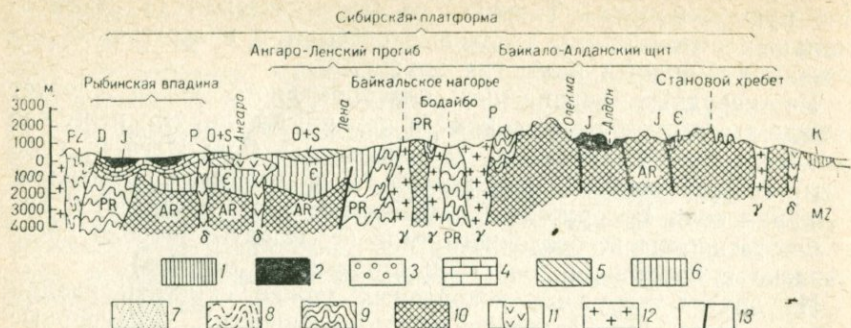
Рис. 145. Геологический разрез через Сибирскую платформу (по М. В. Муратову) 1 — мел; 2 — юра; 3 — пермь; 4 — девон; 5 — ордовиз и силур; 6 — кембрий; 7 — мезозой; 8 — палеозой; 9 — протерозой; 10 — архей; 11 — основные интрузии; 12 — гранитные интрузии; 13 — сбросы и взбросы
