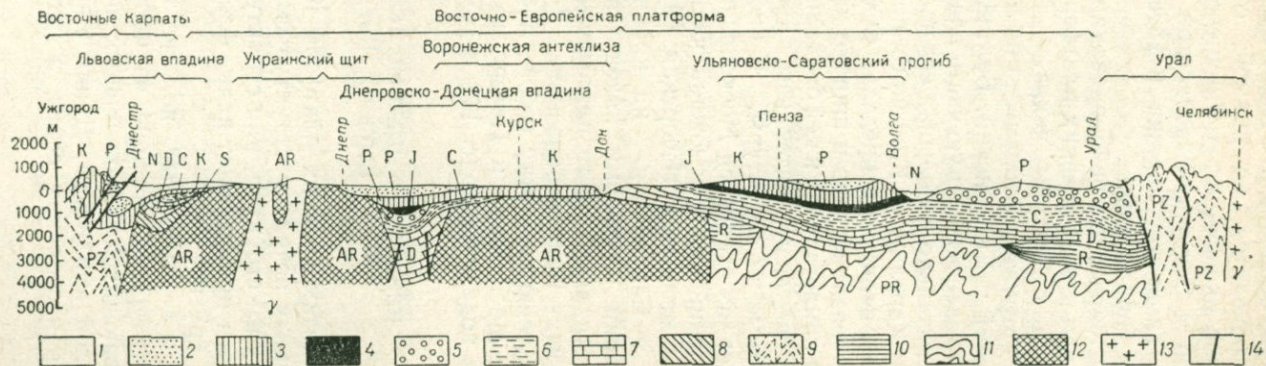
Рис. 143. Геологический разрез через Восточно-Европейскую платформу по линии Восточные Карпаты—Урал (по М. В. Муратову) 1 — неоген; 2 — палеоген; 3 — мел; 4 — юра; 5 — пермь; 6 — карбон; 7 — девон; 8 — силур; 9 — палеозой; 10 — рифей; 11 — про- терозой; 12 — архей; 13 — гранитные интрузии; 14 — сбросы и взбросы
