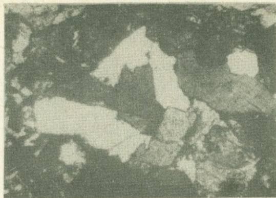
Рис.3.31. Длинные контакты и внедрение зерен под давлением. Полимиктовый песчаник с инкорпорационной структурой. Карбонатно-терригенная флишевая субформация. Снв.15 Раздан, гл.1950-1962 м. Шлиф 488 с анализатором. Увел.90х.
