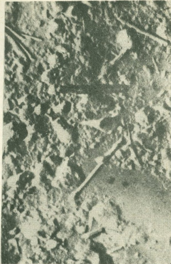
Рис.3.39. Электронномикроскопический снимок (угольная реплика) фракции < 0,001 мм глины, состоящая из монтмориллонита, гидрослюды, палыгорскита или галуазита. Нижнемолассовая формация. Правобережье р.Веди у с.Урцадзор. Обр.2144. Увел.30000х.
