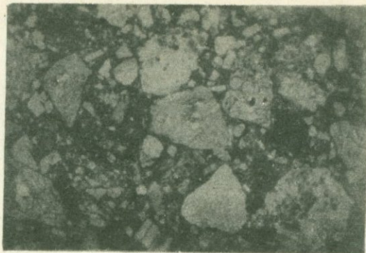
Рис.3.22. Туффит (ортотуффит) псаммитовый с резким преобладанием кристаллолитокластической части над цементом. В центре обломанный кристалл авгита. Вулканогенно-осадочная флишеидная субформация. Район горы Багацсар. Шлиф 4821, увел.30х, без анализатора.
