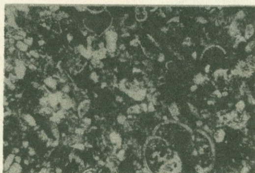
Рис.3.35. Известняк органогенно-обломочный, цельнораковинно-детритовый с псаммо-алевритовой структурой. Карбонатно-терригенная флишевая субформация. Бассейн р.Азат. Шлиф 63, без анализатора. Увел.64х
