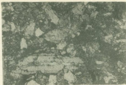
Рис.3.30. Частичное растворение под давлением некоторых участков известковых раковин нуммулитов и внедрение в них острых краев некарбонатных (полевые шпаты, кварц, кварциты, обломки эффузивов) зерен. Карбонатно-терригенная флишевая субформация. Бассейн правобережья р.Веди у с.Урцадзор. Обр.2134, без анализатора. Увел.27.
