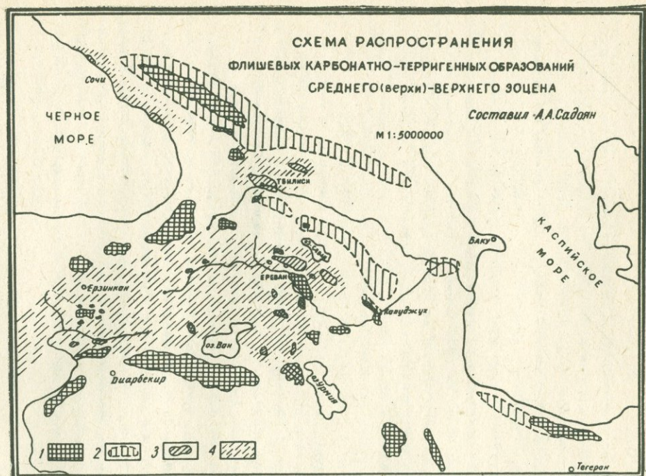
Рис.4.10. Схема распространения флишевых карбонатно-терригенных образований среднего(верхи)-верхнего(низы) эоцена. 1.Суша преимущественно устойчивая, сложенная метаморфическими, осадочными и магматическими породами докембрия и палеозоя. 2.Суша неустойчивая, сложенная преимущественно осадочными и магматическими породами юры и мела. 3.Выходы пород карбонатно-терригенной флишевой субформации. 4.Предполагаемые области распространения пород карбонатно-терригенной флишевой субформации.
